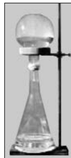
48-сүрөт. \text{HCl} газынын сууда эрип, хлорид кислотасынын эритмесин пайда кылышы
