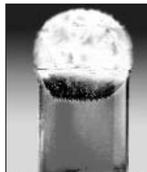
9-сүрөт. Йоддун бөлүкчөлөрүнүн муздак бетте чогулуп, йод затын пайда кылышы
