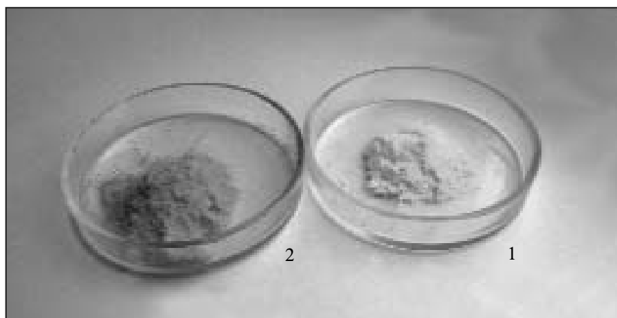
49-сүрөт. Туздардын үлгүлөрү: жез сульфаты \text{FeSO}_4 (1) жана кристаллдашкан сууну кармаган жездин купоросу \text{CuSO}_4 \cdot 5\text{H}_2\text{O} (2).
