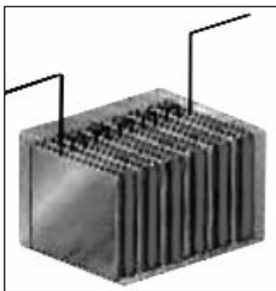
47-сүрөт. Сульфат кислоталуу аккумулятордун батареялары
