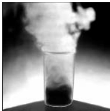
20-сүрөт. \text{H}_2\text{O}_2 ин \text{MnO}_2 нин катышуусунда ажырашы
