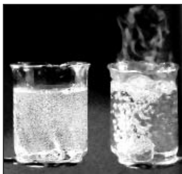
34-сүрөт. Цинктин түрдүү концентрациядагы сульфат кислотасы менен таасирдешүүсү
