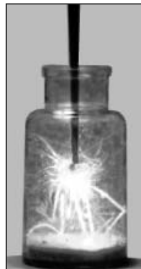
22-сүрөт. Магнийдин таза кычкылтектен күйүшү
