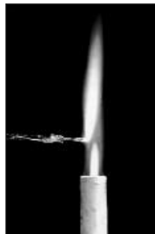
7-сүрөт. Газ горелкасынын жалынында ысытуу
