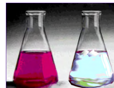
41-rasm. «Quruq muz» va uning fenolftaleini ishqor eritmasi bilan ta'sirlashib, neytrallashishi va indikator rangining yo'qolishi.
