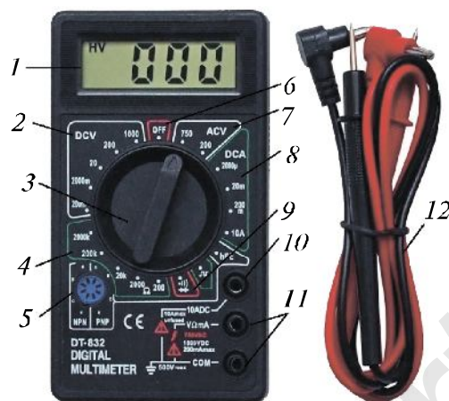
22-сүрөт. DT-832 маркалуу мультиметрдин түзүлүшү: 1 — дисплей; 2 — туруктуу чыналууну өлчөө; 3 — переключатель; 4 — каршылыкты өлчөө; 5 — транзисторлорду текшерүү уячасы; 6 — өчүрүү; 7 — өзгөрмө чыналууну өлчөө; 8 — токтун өлчөө; 9 — туруктуу чыналууну өлчөө; 10 — 10 А болгон токтун өлчөө; 11 — аныктагычтар үчүн уяча; 12 — өлчөө зымдары (шуптар).
