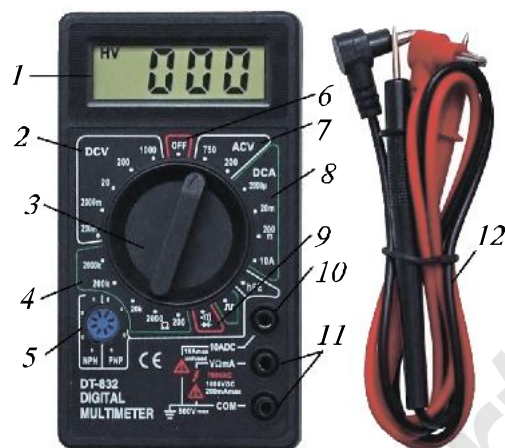
Расми 22. Сохти мултиметри тамгаи DT-832: 1 — дисплей; 2 — ченакҳои қувваи тағйирнопазир; 3 — переключатель; 4 — ченкунии муқовимат; 5 — ҳоначаи санҷидани транзисторон; 6 — ҳом-шкунӣ; 7 — ченкунии қувваи тағйирнопазир; 8 — ченкунии ток; 9 — ченкунии қувваи тағйирнопазир; 10 — ченкунии токи 10 А; 11 — ҳонача барои аниққунандаҳо; 12 — симҳои (шупҳои) ченак.
