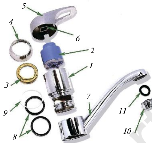
Рисми 16. Сохти асбоби смесители якфишанга (якричагдор): 1—корпуси металлӣ; 2—картрич; 3—гайкаи картичро маҳкамдоранда; 4—сарпўши декоративӣ; 5—дастаки смесител; 6—дастираки дорои шакли мураббаъ, ки зери дастаки смесител ҷойгир аст; 7—бинии даврзананда; 8, 11—ҳалқаҳои резинӣ; 9—ҳалқаи фторопластикӣ; 10—аэратор (тўри ҷимоя).
