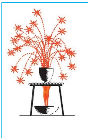
15-súwret. Alyuminiy járdeminde temir oksidin qálpine keltiriw.
