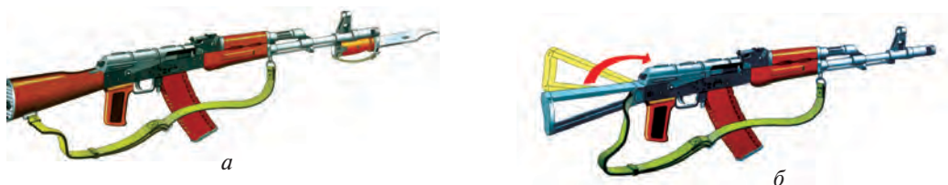
Расми 88. Намуди умумии автомати Калашников: а—АК-74 қундоқи чўбин; б—АКС-74 қундоқи қатшаванда.
