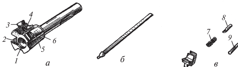
Расми 97. Затвор: а—асоси затвор; б—зарбадиҳанда; в—ҳаводиҳанда; 1—буриш барои гилза; 2—буриш барои ҳаводиҳанда; 3—пешбаранда; 4— чуқурча барои тири ҳаводиҳанда; 5—барҷастаи ҷангӣ; 6—буриш барои боздоранда; 7—пружинаи ҳаводиҳанда; 8—тириҳаводиҳанда; 9—исканҷа.
