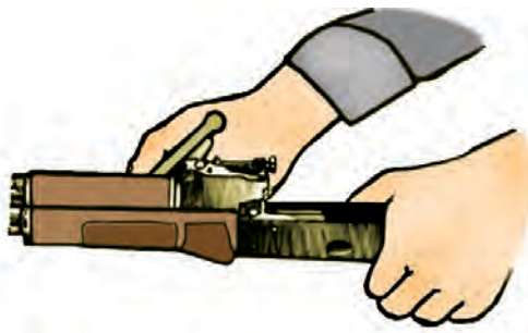
Расми 112. Чудо кардани трубкаи газ аз қундоқи мил.
