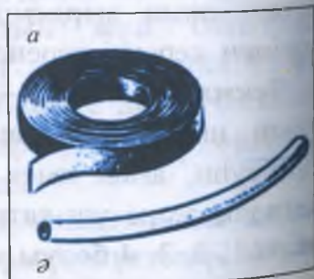
71-сурет. Оқшаулағыш таспа (а) және түтікше (ә).
