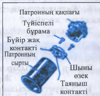
77-сурет. Аспалы патронның құрылымы.
