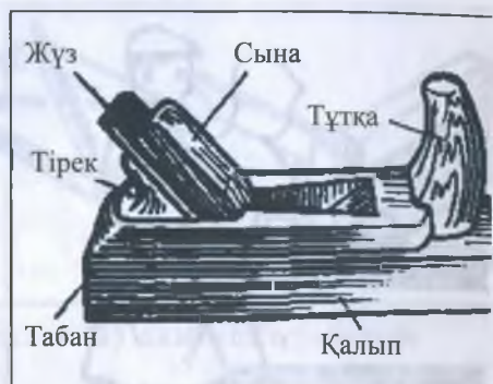
51-сурет. Сүргінің құрылымы
