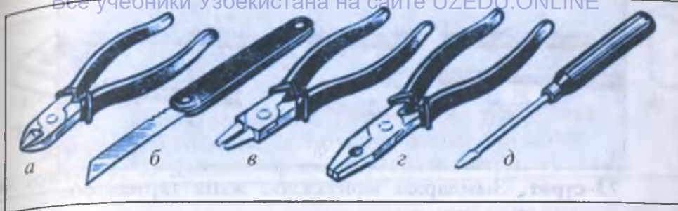
72-сүрөт. Электр монтаж шаймандары: а) курч жаактуу аттиш; б) монтаж бычагы; в) тоголок жаактуу аттиш; г) жалпак жаактуу аттиш; д) отвёртка.
