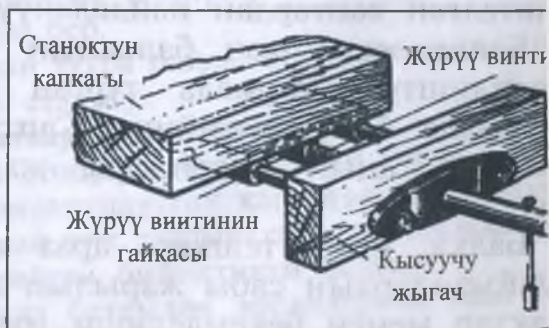
38-сүрөт. Жыгаччылык станогунун кыскычы.
