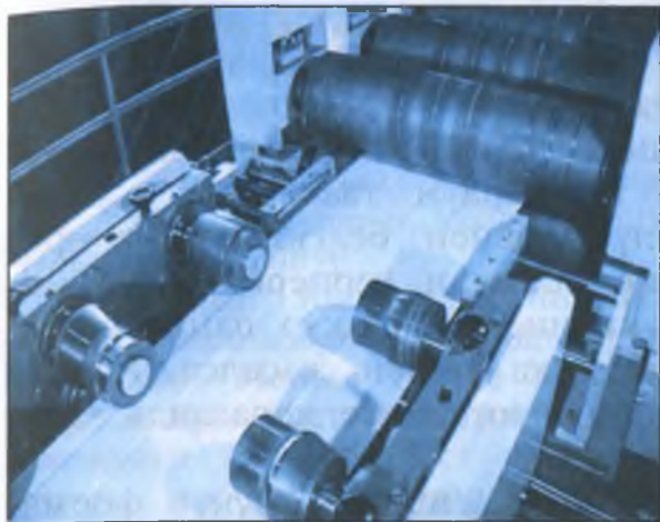
3-сүрөт. Металлды прокаттоо станогун жана анын схемасы.
