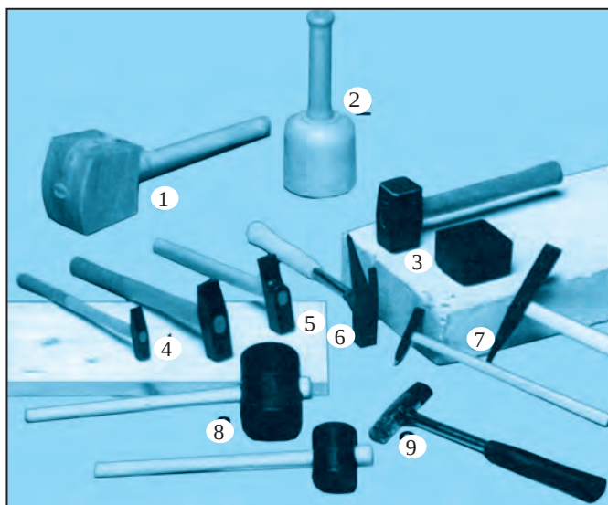
Расми 13. Болғаҳои челонгарӣ ва болғаи чўбин: 1,2 – болғаҳои чўбин; 2, 4, 5, 6, 7 – болғаҳои фўлодин, 8–9 болғаҳои пластикӣ (чандирӣ).
