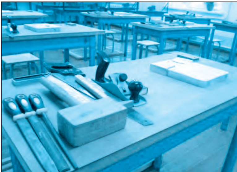
Расми 37. Дастгоҳи дуредгарӣ ва дар он ҷойгиршавии анҷомҳо.
