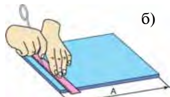
43-сүрөт. Сызуу: а – циркуль менен; б – кернер менен.
