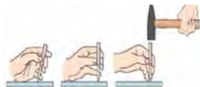
64-сүрөт. Плитанын үстүндө кесүүдө зубилону кармоонун усулдары.
