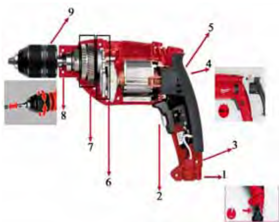
10-сүрөт. Электр кол көзөөчтүн түзүлүшү:
