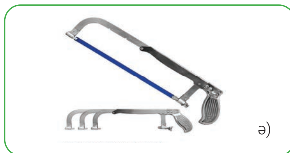
31-сурет. Слесарлық араларының түрлері: а) сапты; ә) станокты.
