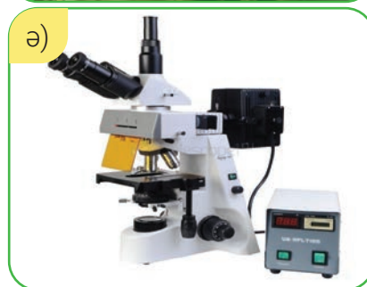
23-сурет. Металл сынау құралдары: а) заманауи металл сынау жабдығы; ә) металды микроскоп көмегінде сынау.
