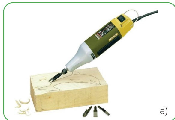
14-сурет. Электр қашау: а) электрлі қашау; ә) жұмыс үдерісі.
