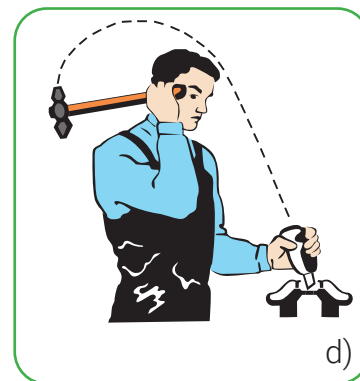
43-súwret. Shókkish penen urıw usılları: a) pánje urıwı ; b) shıganaq urıwı ; d) iyin urıwı .
