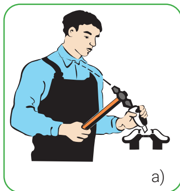
43-súwret. Shókkish penen urıw usılları: a) pánje urıwı ; b) shıganaq urıwı ; d) iyin urıwı .
