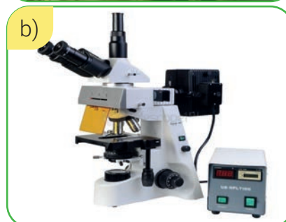
23-súwret. Metall sinaw ásbapları: a) zamanagóy metall sinaw úskenesi; b) metaldı mikroskop járdeminde sinaw.
