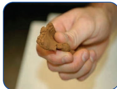
3) mexanikalıq quramı ortasha saz topıraqtı lenta formasına keltiriw procesi
