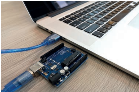
5-сúwрет. Programmanı Arduino UNO platasına jazıw.
