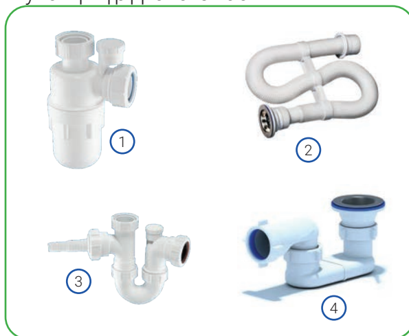
57-сүрөт. Сифондун түрлөрү: 1. Айнектүү; 2. Гофрирлүү; 3. Түтүктүү; 4. Жалпак.
