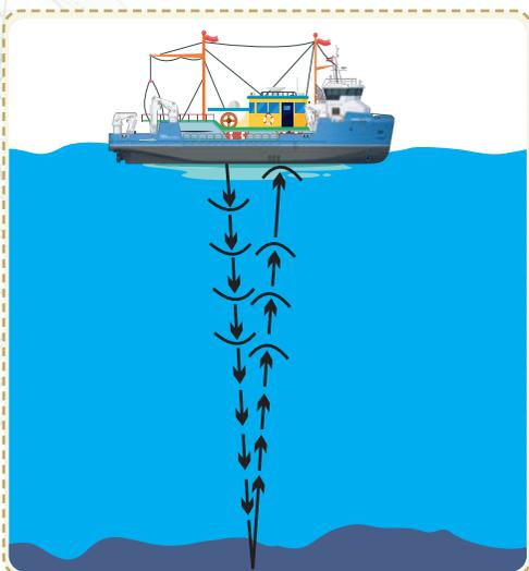
13. *Измерение расстояний эхолокацией.* Для корабля, плывущего в море, очень важно знать глубину моря. Для этого посылается звуковой сигнал ко дну и на корабле подсчитывается время, за которое сигнал возвращается, отразившись от дна.
