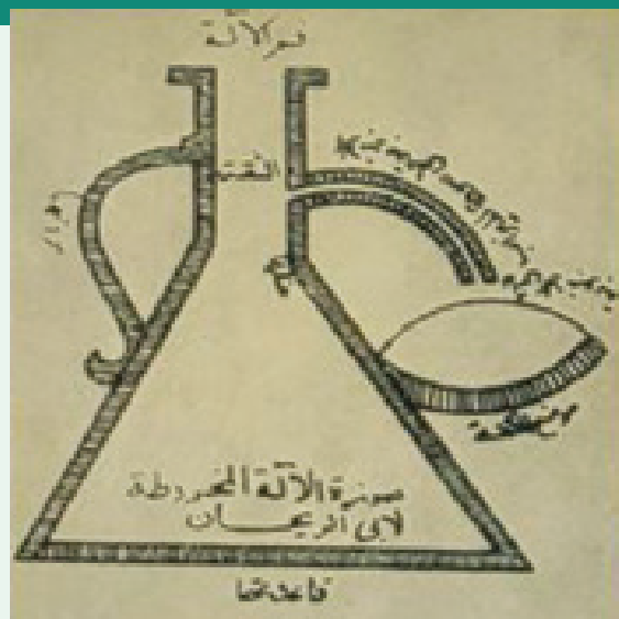
Abu Rayxan Beruniy «Mineralogiya». IX ásir. Suwǵa túsirilgen úlgi tiykarında qısıp shıǵarılǵan suyuqlıqtıń kólemin anıqlaw úskenesiniń sızılması.
