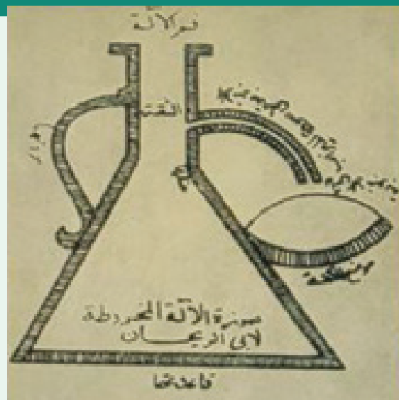
Абу Райхан Беруни «Минералогия». IX век. Чертёж устройства для определения объёма жидкости, вытесненной телом, погружённым в воду.
