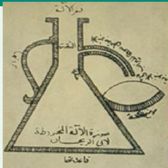
Abu Reýhan Biruny «Minerologiya». IX asyr. Suwa düşürilen nusga tarapyndan gysyp çykarylan suwuklygyň göwrümini kesgitleýän gurluşyň çyzgysy.
