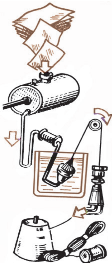
25-сүрөт. Химиялык булаларды алуу жараяны.
