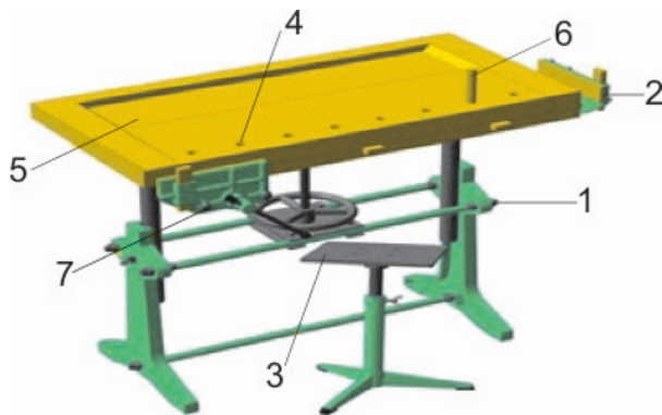
7-сүрөт. Жыгач устачылык станогу: 1 – негиз; 2 – кыскыч; 3 – иш столу; 4 – жардамчы уялар; 5 – иштөө берүү жайы; 6 – жардамчы тирөөчтөр; 7 – тиски.
