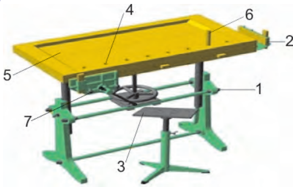
Рис. 7. Столярный верстак: 1 – основа; 2 – зажимы; 3 – рабочий стол; 4 – вспомогательные отверстия; 5 – место для обработки; 6 – вспомогательные крепления; 7 – тиски.
