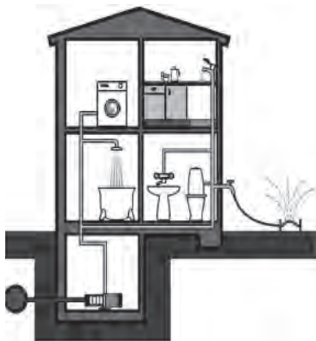
Рис.61. Схема водоснабжения в жилых зданиях.
