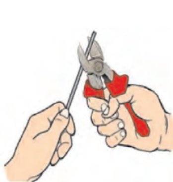
Рис.28. Разрезание проволоки кусачками.
