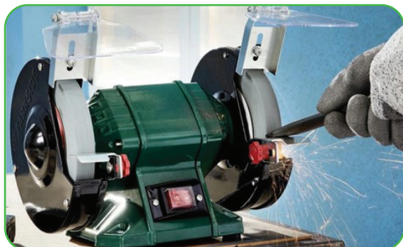
55-сүрөт. Зубилону курчутуу жараяны
