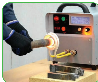
50-сүрөт. Частоталуу электр тогунун жардамы менен бетти кыздыруу
