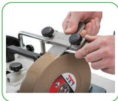
15-сүрөт. Чарктоочу станокто курчутуу
