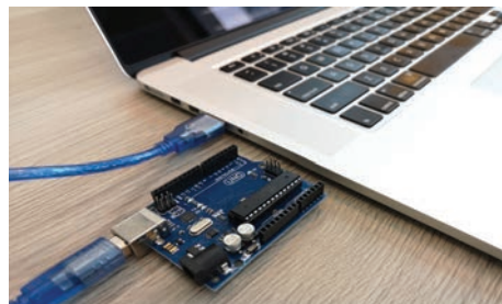
4-сүрөт. Программаны Arduino UNO платасына жазуу
