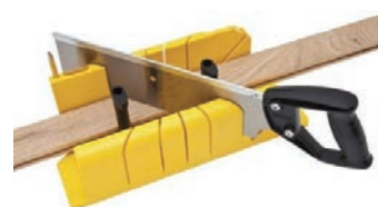
20-сүрөт. Порси калыптын жардамы менен араалоо.
