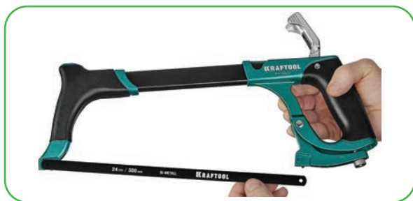
Рисунок 57. Монтаж полотна рычажным способом
