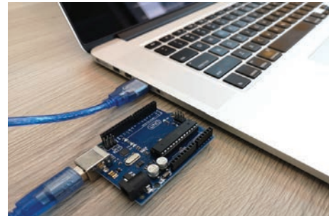
Рисунок 4. Запись программы на плату Arduino UNO
