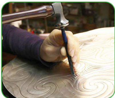
Рисунок 70. Рабочий процесс чеканки
