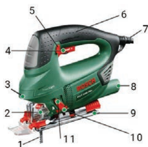
Рисунок 37. Устройство электролобзика. 1 – полотно лобзика; 2 – устройство быстрого хода; 3 – устройство освещения; 4 – кнопка пуска и колесо ускорения хода; 5 – блокирующее устройство управления кнопкой; 6 – рукоятка; 7 – электрошнур; 8 – трубка для отвода стружки; 9 – подошва; 10 – кнопка обдува; 11 – кнопка, направляющая маятник.
