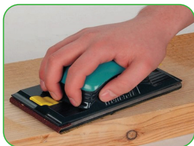
Рисунок 43. Способы закрепления наждачной бумаги
