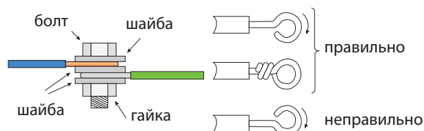
Рисунок 93. Соединение проводов с помощью болта
