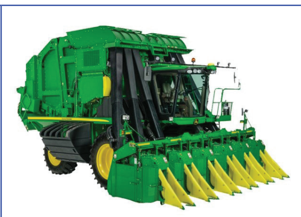
Расми 19. Мошини пахтачинӣ бо шпиндели горизонталӣ.
