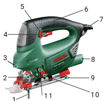
Расми 37. Сохти лобзики электрикӣ: 1 –полотнои лобзик; 2 – дастгоҳи полотноро зуд ивазкунанда; 3 – дастгоҳи равшанӣ; 4 – тугмаи оғоз ва қарҳи танзими суръат; 5 – тугмаи бастани тугмаи идоракунии; 6 – даста; 7 – сими барқӣ; 8 – трубаи тозакуандаи паҳолҳо; 9 – асос; 10 – дастгоҳи ҳаводеҳӣ; 11 – тугмачае, ки гашти маятникро рост мекунад
