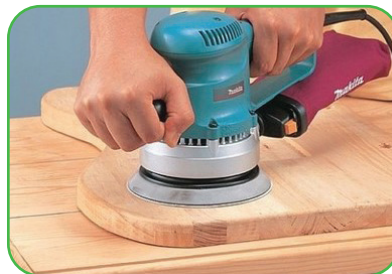
Расми 47. Дастгоҳи суфтакунандаи эксцентриқӣ.
