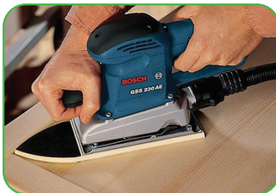
Расми 46. Дастгоҳи суфтакунӣ дар шакли нишеб.
