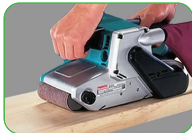
Расми 45. Дастгоҳи суфтакунии тасмагӣ (лентагӣ).
