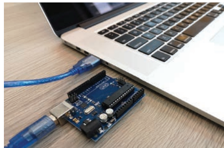
Расми 4. Навиштани барнома дар дастури Arduino UNO
