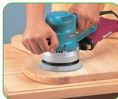
47-rasm. Ekssentrik silliqlash mashinasi
