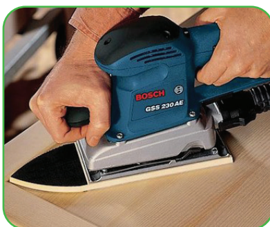
46-rasm. Delta ko'rinishidagi silliqlash mashinasi
