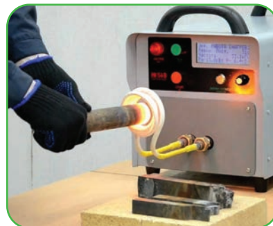
50-rasm. Sirtni yuqori chastotali elektr toki yordamida toblash
