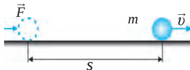
134-súwret. v tezligine iye shariktiń kinetikalıq energiyası. energiyası
